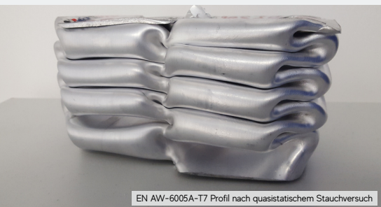
EN AW-6005A-T7 Profil nach quasistatischem Stauchversuch
